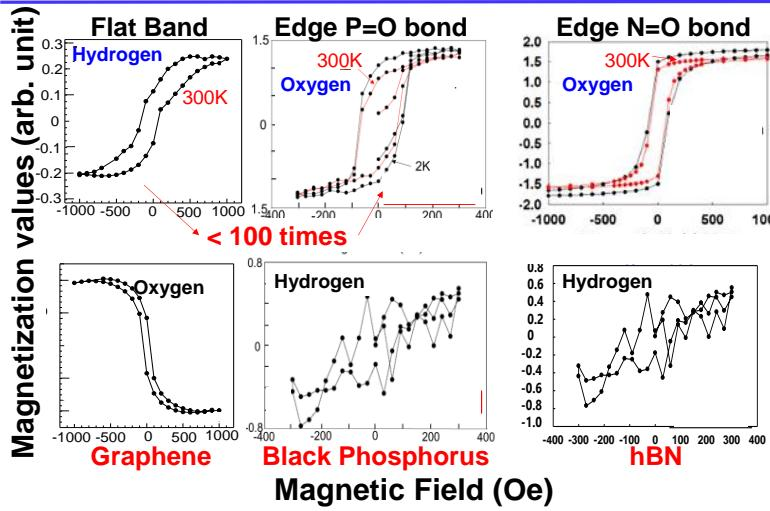
二次元原子層物質(2D AL)の端（エッジ）の特異な原子配列は興味深い電子・ спин現象をもたらしますが、1つの試料中のエッジの量は少なく、欠陥も多いのが問題です。そこで当研究室では、多様な2D AL上にリソグラフィを用いずに超低欠陥・低汚染ナノメッシュ構造を形成、磁性・スピニ現象を報告してきました。これまでにグラフェン、hBNなどで細孔エッジからの室温強磁性の発現を報告しましたが、今回最新の2D AL物質である黒リンを酸化する事で巨大な室温強磁性が発現する事を発見しました。これはエッジP=O(リン・酸素)ボンドにおける強磁性スピニ配列の出現によるものと考えられ、酸化され易いという黒リンの欠点を逆に活用して、エッジO原子のスピニを偏極させた結果です。大気中に放置するだけで巨大な磁化が得られるため、希少磁性元素を用いない磁気・スピニ素子として今後の応用が大いに期待されます。
